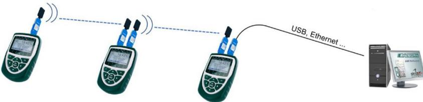
3. Verbindung von mehreren ALMEMO® Messgeräten untereinander und drahtlose Anbindung zu einem PC
