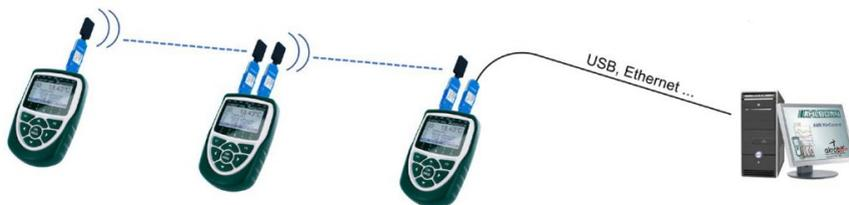
3. Connexion de plusieurs appareils de mesure ALMEMO® entre eux et raccordement sans fil sur un PC
